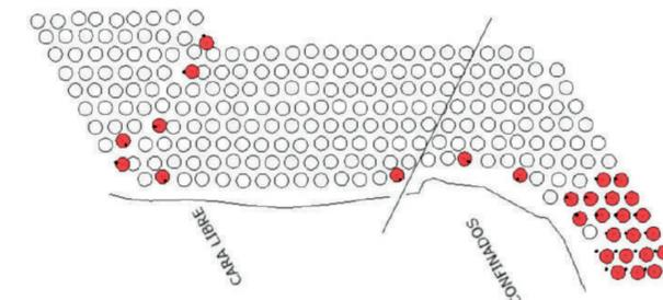
Malla de perforación y corrección de posición de barrenos – Informe ORICA BLAST ENGINEERING.
