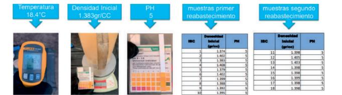
Pruebas y ensayos para control de calidad de la emulsión de voladura.
