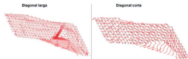
Imagen del software con los tiempos de salida de cada barreno.
