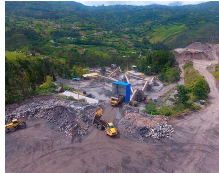
Cabina de tolva principal con sistema de aspersión independiente que se activa con un sensor cuando se acerca una volqueta con material de la mina.
