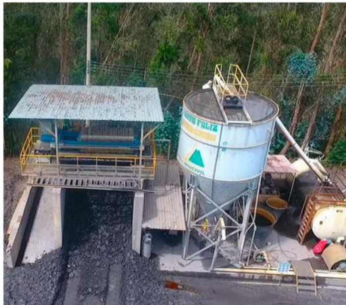
Sistema de clarificación y filtro prensado.
